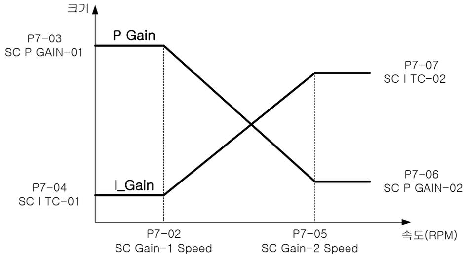
속도 제어기의 이득을 속도 영역에 따라 상이한 값으로 적용할 경우에 사용하십시오. 특히, 저속과 고속의 적용 Gain 값이 서로 다를 경우에 적용하시기 바랍니다.
