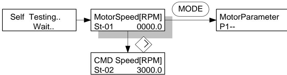
초기에 전원을 투입한 상태에서 알람이 없고, 초기 메뉴 설정치가 모터 속도로 설정되어 있다면 위와 같이 [Motor Speed[RPM](St-01)]를 표시합니다.
