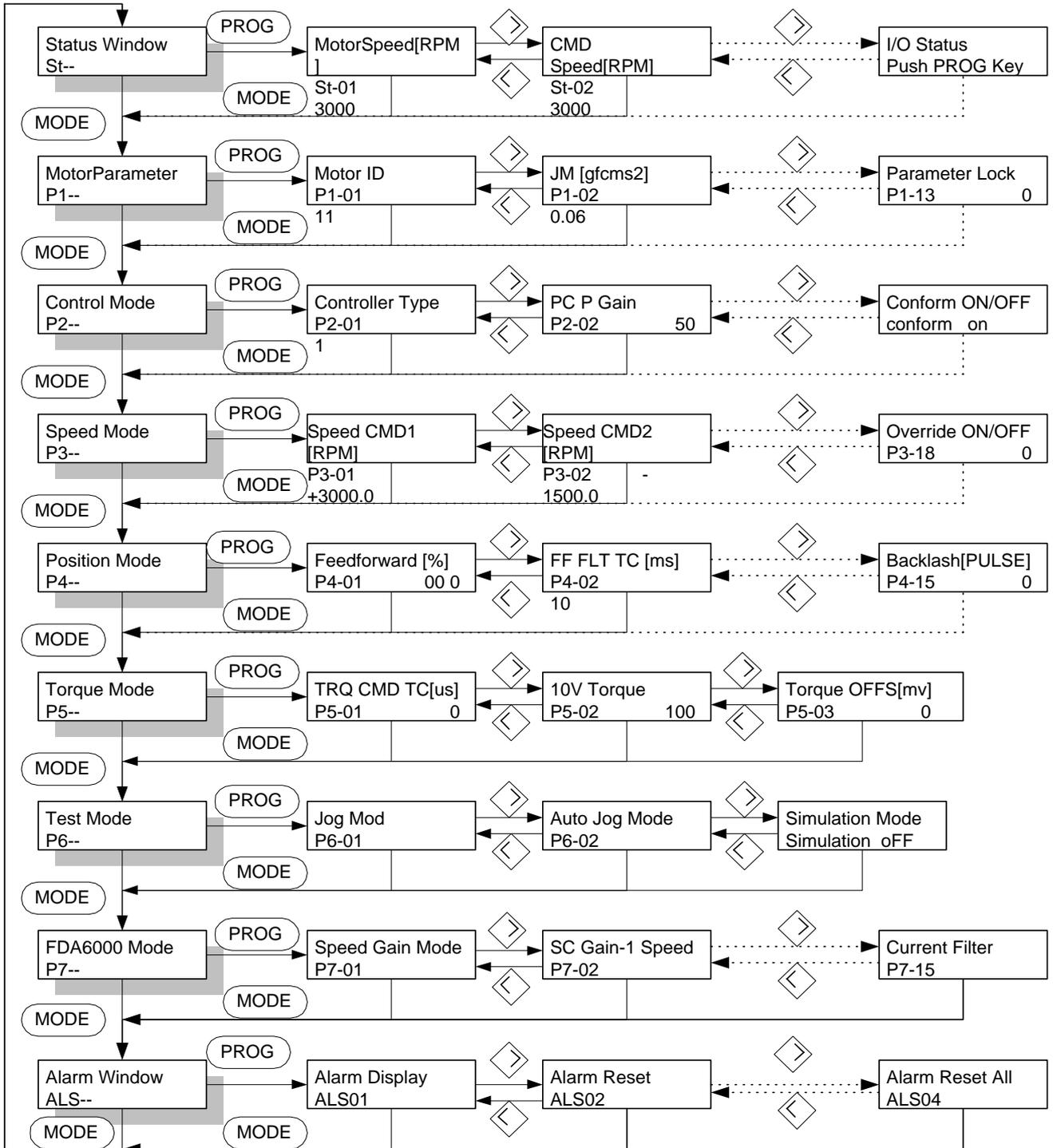
그림 4.2 조작 방법 블록도
