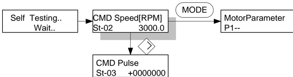
초기에 전원을 투입한 상태에서 알람이 없고, 초기 메뉴 설정치가 지령 속도로 설정되어 있다면 위와 같이 [CMD Speed[RPM](St-02)]를 표시합니다.
