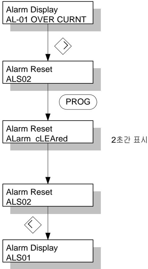
현재 알람 리셋[Alarm Reset(ALS-02)] 메뉴는 현재 시스템에 발생한 알람을 리셋(Reset)하는 것으로 외부 입력 리셋과 동일한 기능입니다.
