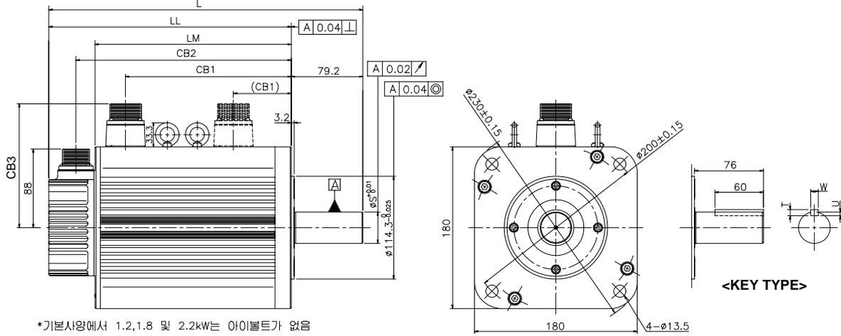
**Taper Shaft(음선)형 (점선부는 Brake 부착형 Connector 위치임.)**
